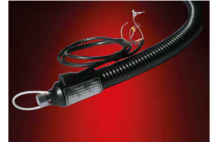
ELH/mdw-200 °C-DN10 Beheizter Druckschlauch mit Heizkabelüberstand zum beheizen der Anschlussarmatur; Anwendung: Anlagenbau / Transport von Öl und Fett für eine Beschichtungsanlage
