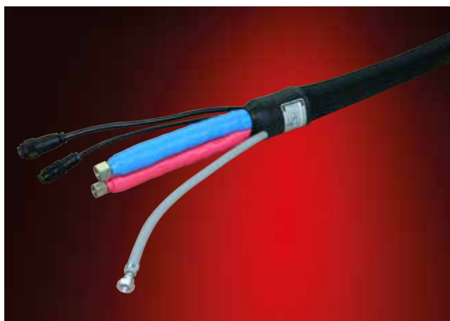
ELH-3mdN-SP, 80 °C Beheizter Druckschlauch mit 2 beheizten Innenseelen und zusätzlicher Druckluftleitung Anwendung: Beschichtungstechnik / 2K-Polyurea-Anlage
