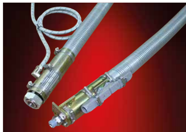
ELH-hdT 200 °C, NW 16 beheizter Druckschlauch in trittfester Ausführung mit Metallwellenschlauch als Außenmantel, zusätzlicher Beileitung und Spezialendkappe; Anwendung: Bitumentchnik
